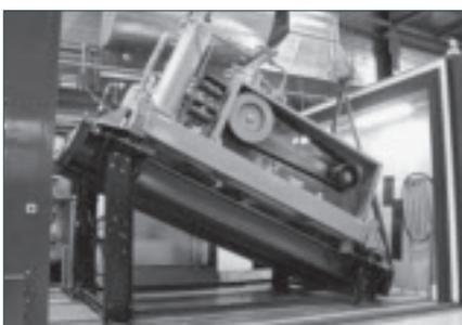
Jeder Kompressor wird vor dem Verlassen unseres Werkes einem kompletten Test von mindestens 8 h auf den vollelektronischen High-End-Prüfständen unterzogen.
